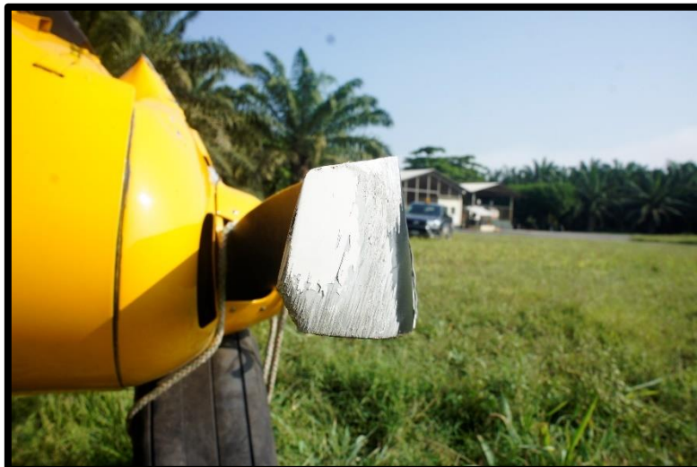
Fotografía No. 5 Vista lateral del asa golpeada.
