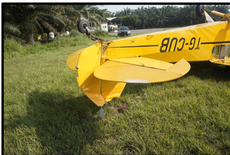
Fotografía No. 8 Vista de los daños en el empenaje.
