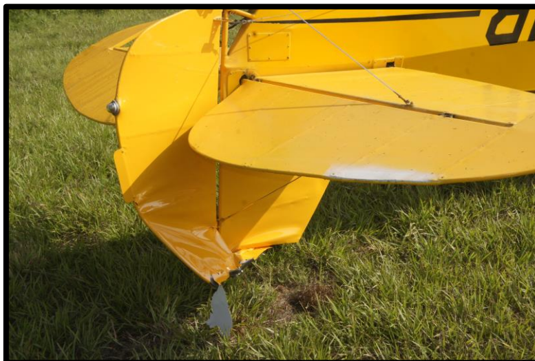
Fotografía No. 9. Vista de los daños en el estabilizador vertical y rooder.
