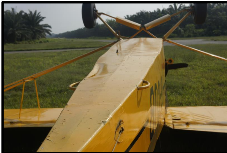
Fotografía No. 13. Vista de los daños en la parte inferior del fuselaje.
