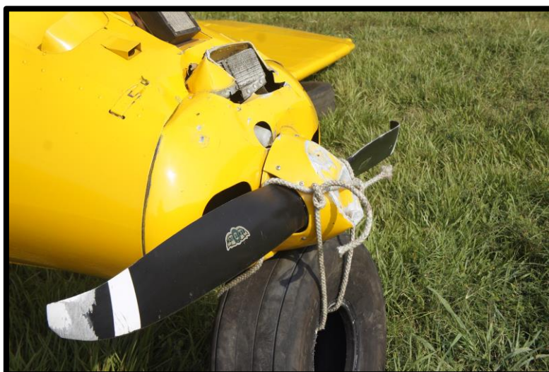
Fotografía No. 4. Vista de los daños en el spinner y las aspas de la hélice.
