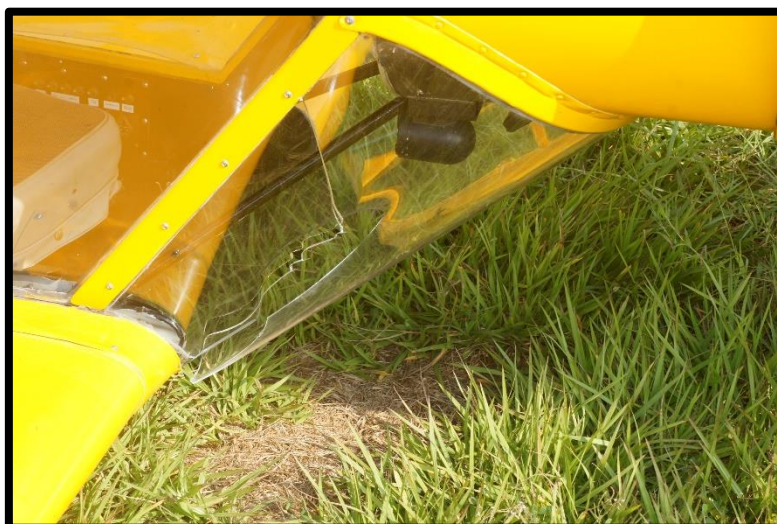
Fotografía No. 6 Vista del parabrisas quebrado.
